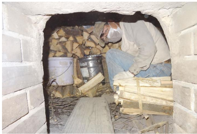
炭焼き窯内＝原木の詰め込み
